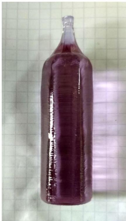
Рис. 1. Фотография монокристаллической булы  $\text{LaMgAl}_{11}\text{O}_{19}:\text{Nd}$  15 ат.%, выращенной в направлении (0001).
