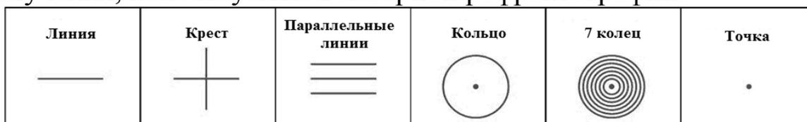
Рис.1. Виды структурированного лазерного излучения
