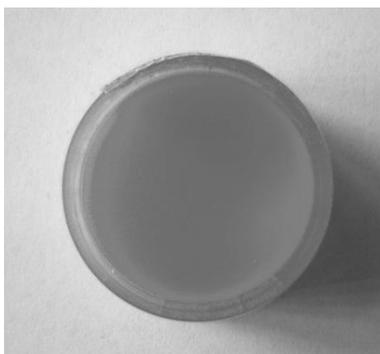
Рис. 1. Активный лазерный элемент на основе активированного полиуретана
