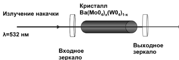
Рис. 2. ВКР-преобразователь
